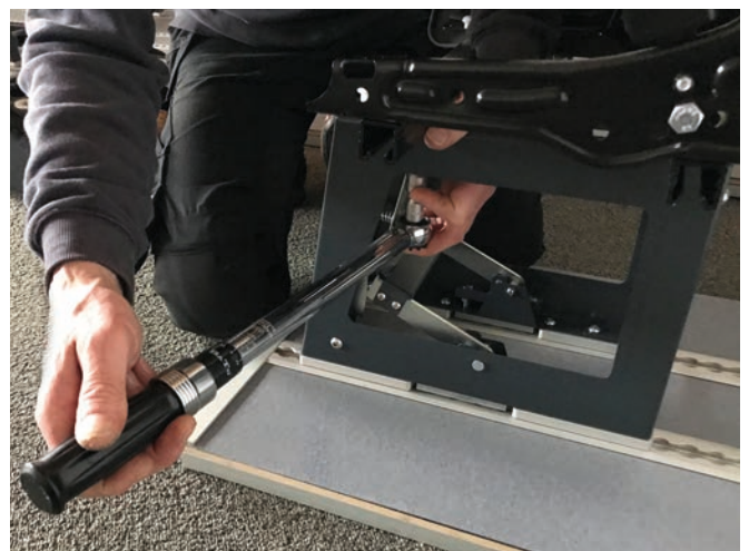
– mit 50 Newton anziehen
