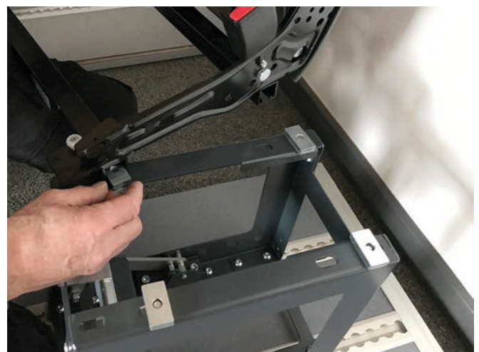
Drehen Sie die Gleitmuttern in eine horizontale Position
