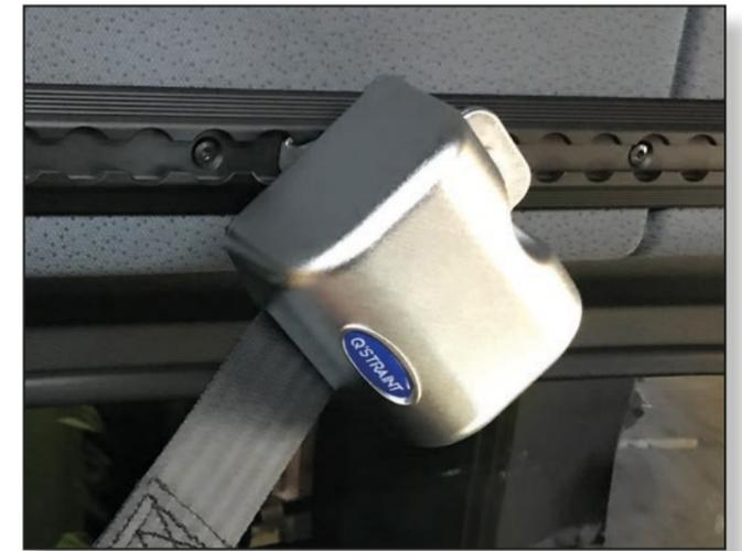
▶ Drehen Sie die Gurtkassette in einem Winkel nach unten.
