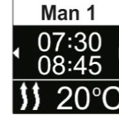
Alle programmerte tider kan deaktivertes, behandles og slettes. Hvis symbolet "Timer" velges i hovedmenyen, vises alle lagrede tider kronologisk i displayet. Etter valg av ønsket tid, står funksjonene "aktiver", "deaktivert", "behandle" og "slette" til disposisjon.
